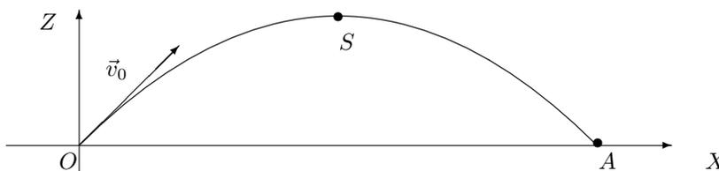
Le point  $S$ , sommet de la parabole, a pour coordonnées  $(v_1 v_3 / g, v_3^2 / (2g))$  ; ce point est atteint au temps  $t = v_3 / g$ .
