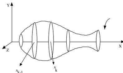
Pour  $k$  fixé, il s'agit du tronc de cône de longueur d'arête égale à la longueur du segment joignant les points du graphique de  $f$  d'abscisses  $x_{k-1}$  et  $x_k$  et de bases de rayons  $f(x_{k-1})$  et  $f(x_k)$ . L'aire latérale de ce tronc de cône est donc
