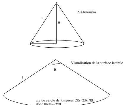
L'aire complète du disque de rayon  $l$  est  $\pi l^2$  donc l'aire du secteur représenté ci-dessus, c'est-à-dire l'aire latérale du cône, est
