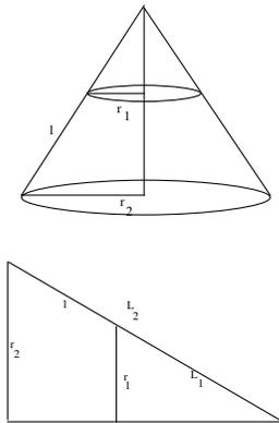
L'aire latérale  $S$  de ce tronc de cône est donc  $S = \pi (r_2 L_2 - r_1 L_1)$ . L'utilisation de triangles semblables donne lieu à l'égalité  $\frac{L_1}{r_1} = \frac{L_2}{r_2}$ . Il s'ensuit qu'en utilisant cela et  $l = L_2 - L_1$ , on trouve
