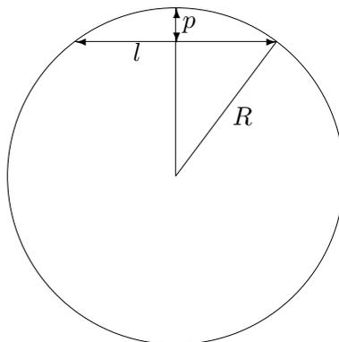
Une approximation de la profondeur maximale de ce tunnel vaut  $\frac{l^2}{8R}$ .
