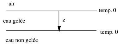
Soit  $z(t)$  l'épaisseur de la couche de glace à l'instant  $t$ . Si le système est sous caractéristiques thermiques constantes, on a
